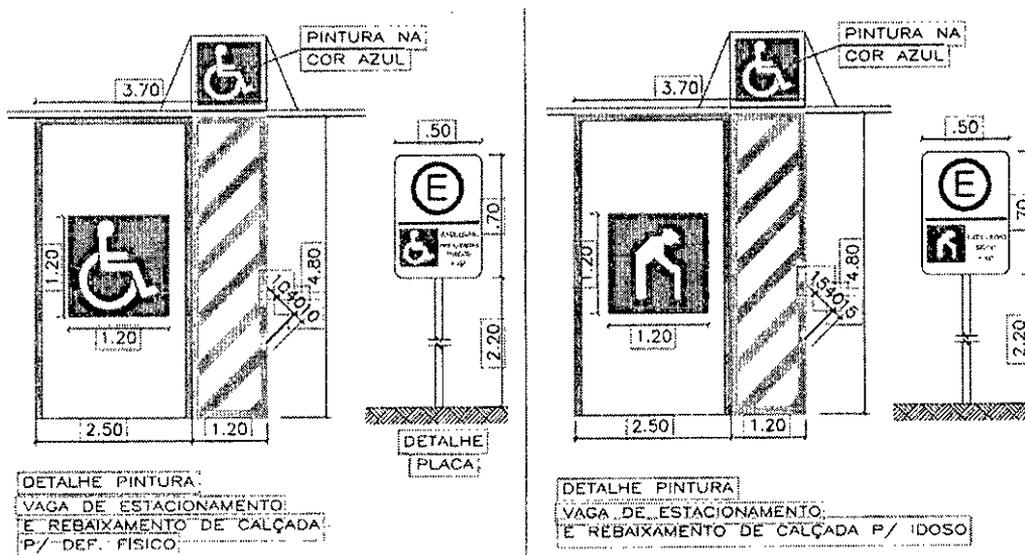
VAGA DE ESTACIONAMENTO PNE PARALELA AO MEIO-FIO:
