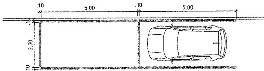
VAGA DE ESTACIONAMENTO PERPENDICULAR AO MEIO-FIO:
